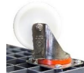
NY INOX - Nylon blanc sur chape et visseries inox CU 500 kg Destiné au secteur de l'agroalimentaire
